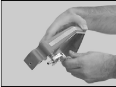
(D) Remove the Blade Guard Intake Fitting
