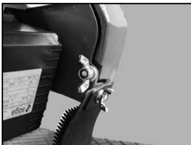
(D) Loosen the Blade Guard Pivot Point Retaining Wingnut.
