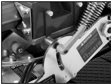
(D) Loosen the Cutting Head Height Lock.
