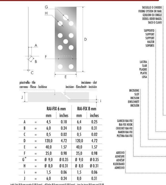
tutti i fori 8 8 mm eccetto G (Ø 9 mm). - all holes Ø 8 mm except G (Ø 9 mm). - tous les trous Ø 8 mm sauf G (Ø 9 mm). - alle Löcher Ø 8 mm, außer G (Ø 9 mm). - todos los agujeros de Ø 8 mm, excepto G (Ø 9 mm).
