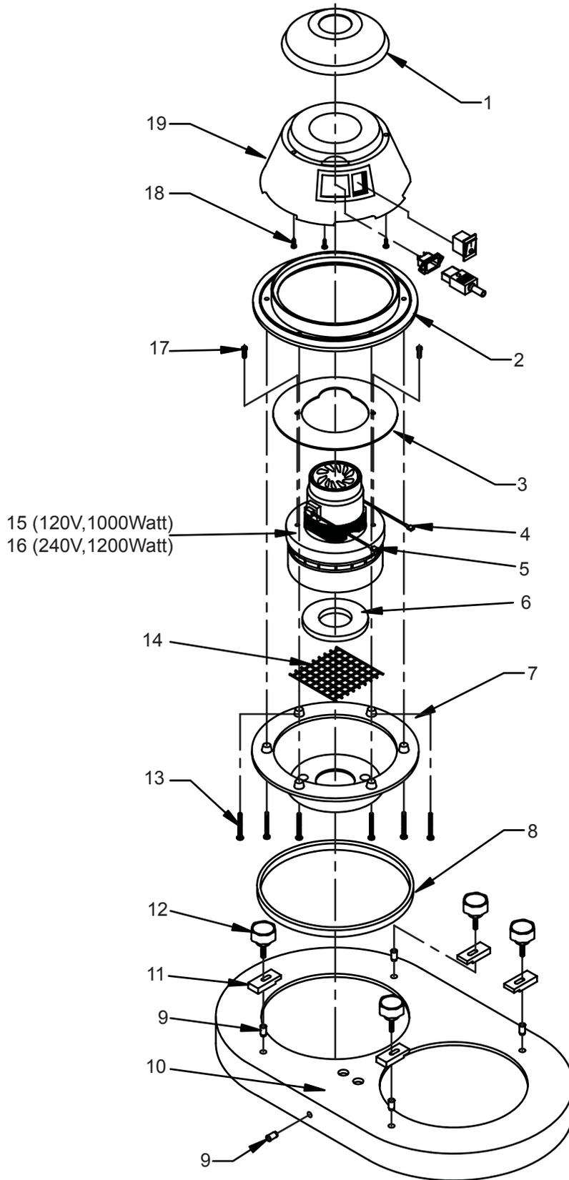
**PARTS LISTING - ILLUSTRATION #2 : 2220 MOTOR DECK ASSEMBLY**
