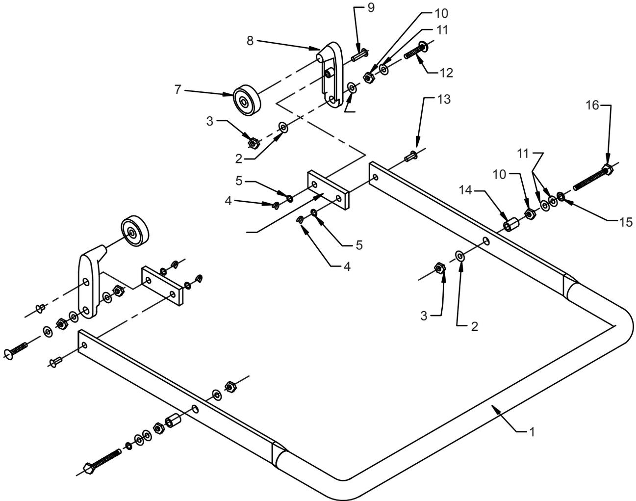
**PARTS LISTING - ILLUSTRATION #8 : DUST PAN LEVER ASSEMBLY**
