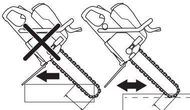
En principio hay dos métodos para iniciar el trabajo de entrada en un objeto grueso para cortarlo.
