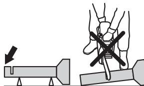
Si se permite que el tubo se hunda y se cierre el corte, la espada se atascará en la zona de reculada y podría producirse una reculada grave. Si la tubería está sujetada correctamente, el extremo de la tubería se moverá hacia abajo, se abrirá la zona cortada y no se producirá ningún atasco.
