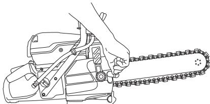
Une chaîne suffisamment serrée doit pouvoir être facilement guidée à la main.
