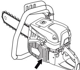
**ATTENTION !** Une prise d'air sale ou bouchée provoque la surchauffe de la machine, ce qui endommage le piston et le cylindre.
