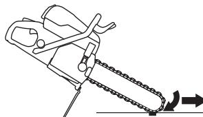
No traslade la máquina cuando el equipo de corte gira. Las fuerzas giroscópicas pueden obstaculizar el movimiento deseado.
