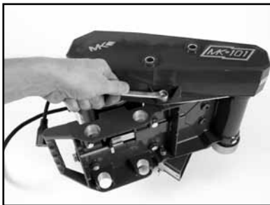
(D) Remove Belt Guard bottom bolt
