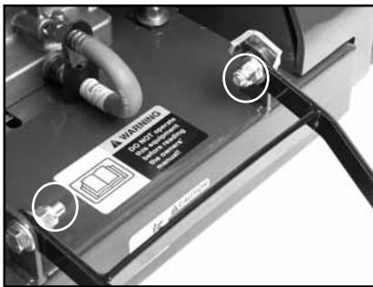
(D) Lubricate the pivot point of the Pointer.
