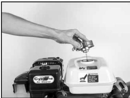
(D) Install Fuel Cap. DO NOT over-tighten.
