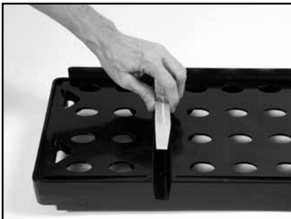
(D) Replace worn Protective Wooden Strip.
