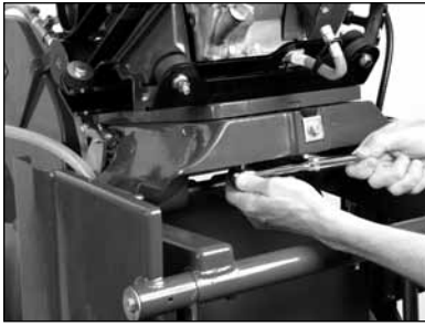
(D) Loosen engine mounting plate If re-tensioning, go to step J.
