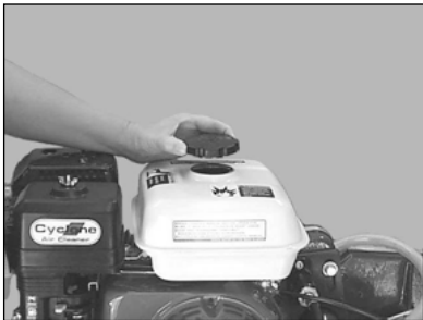
(D) Install Fuel Cap DO NOT over-tighten.
