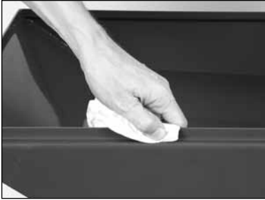
(D) Clean the Movable Cutting Table Guide Rails.
