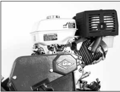
(D) Inspect Engine for leaks.
