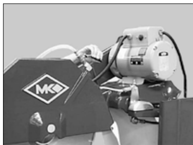
(D) Open the Cooling Flow Control Valve and adjust flow
