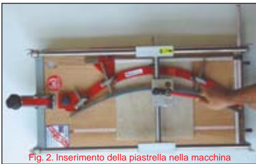
Fig. 2. Inserimento della piastrella nella macchina
