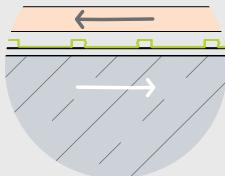
Compensa le tensioni e i movimenti tra la struttura di supporto (massetto in cemento o strutture in legno) e la pavimentazione, cercando di evitare eventuali cedimenti o crepe delle piastrelle.
