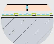
Impermeabilizzazione grazie al materiale (PE HD). La membrana blocca sullo strato superiore le eventuali infiltrazioni d'acqua favorendone il normale processo di evaporazione. Protegge così il massetto dalla percolazione d'acqua evitando dunque la formazione di ghiaccio in caso di temperature molto rigide.
