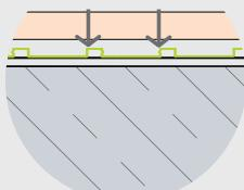
Il collante, penetrando nelle cavità circolari, forma una solida struttura di supporto a colonne che consente di raggiungere, prima fra tutte le membrane a basso spessore, il grado 14 (Extra-heavy commercial) del Robinson Wheel test (il test del TCNA americano, "Tile Council National Association", vero standard di settore) (ASTM C627).
