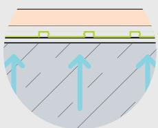
Gestione dell'umidità di risalita in caso di posa su massetto cementizio, che permette di posare il pavimento senza attendere il normale tempo di maturazione del calcestruzzo (28gg).
