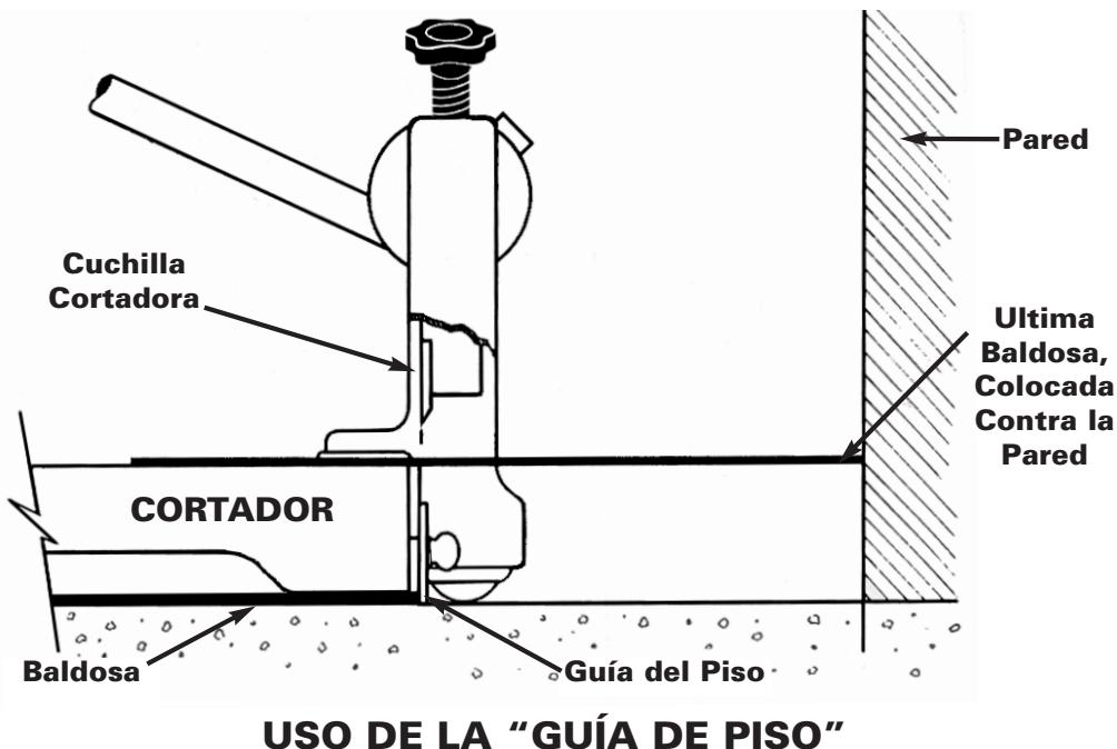
tornillos plásticos, es una guía muy útil para cortar la última baldosa contra la pared. Fije la guía de piso lo más bajo posible, y coloque la guía contra la última baldosa, como se muestra en el dibujo.
