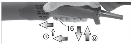
**Conexión:** encienda la máquina tal y como se describe más arriba. Ahora volver a deslizar hacia delante el interruptor (16) y soltarlo en la posición delantera para que el interruptor (16) quede bloqueado (funcionamiento continuado).
