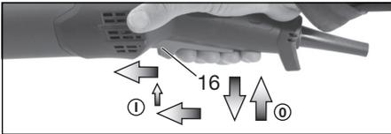
**Mise en marche** : mettre la machine en marche tel que décrit ci-dessous. Pousser à nouveau la gâchette (16) vers l'avant et le relâcher en position antérieure pour bloquer la gâchette (16) (déclenchement).
