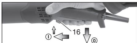
**Conexión:** deslice el interruptor (16) hacia delante y después presione hacia arriba el interruptor (16).
