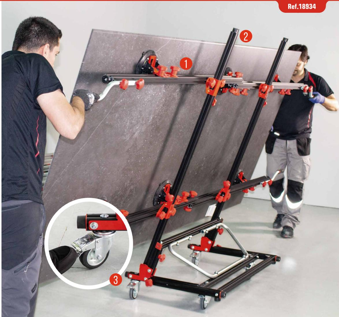
**ES** Sistema de transporte y maniobra para cerámicas de gran formato usando el SLAB TRANS HEAVY DUTY (18936) o SLIM EASY TRANS (18910) + ACCESORIO BARRAS TRANSVERSALES (18819).
