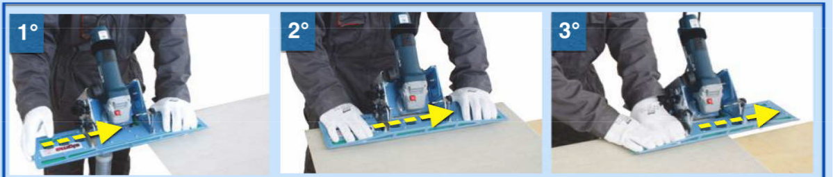
Lavorazione "MEZZO TORO" con mola. Half Bullnose processing with grinding wheel.
